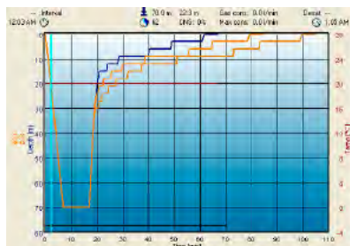
Schéma 1 – Effet des réglages du niveau de MB sur le profil de plongée. MB 0 = bleu, MB3=jaune, MB5=marron.
