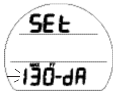
Fig. 21 - RÉGLAGE DE L'ALARME DE PROFONDEUR
