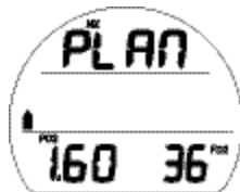
Fig. 8B - ÉCRAN D'ACCÈS AU MODE PLAN (mélange gazeux 1 réglé sur Nitrox)
