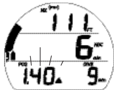
Fig. 73 - ÉCRAN PRINCIPAL D'ALARME PO2
