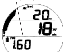
Fig. 74 - ALARME PO2 (pendant une phase de décompression)
