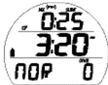
Fig. 3A - ÉCRAN PRINCIPAL DU MODE SURFACE NORM (aucune plongée effectuée jusque là)
