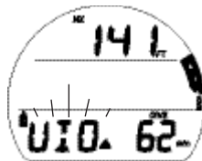
Fig. 70 - ÉCRAN PRINCIPAL D'INFRACTION AVEC LIMITATION AU MODE PROFONDIMÈTRE
