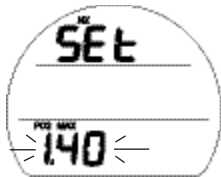
Fig. 25 - RÉGLAGE DE L'ALARME PO2
