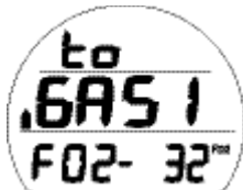
Fig. 78 - PRÉVISUALISATION DU PASSAGE AU MÉLANGE GAZEUX 1
