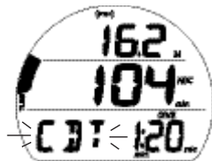
Fig. 105 - ALARME DU MINUTEUR DE COMPTE A REBOURS
