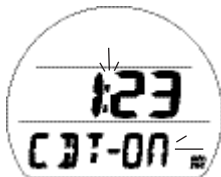
Fig. 94 - ÉTAT DU MINUTEUR DE COMPTE A REBOURS (On, en cours)
