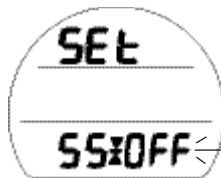
Fig. 30A - RÉGLAGE D'UN PALIER DE SÉCURITÉ SUR OFF
