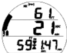
Fig. 58 - ÉCRAN PRINCIPAL DE PALIER PROFOND
