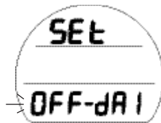
Fig. 99A - RÉGLAGE DE L'ALARME DE PROFONDEUR DA1
