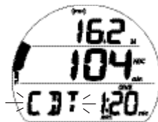
Fig. 105 - ALARME DU MINUTEUR DE COMPTE A REBOURS
