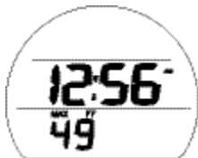
Fig. 104 - ÉCRAN COMPLÉMENTAIRE ALT 2 DU MODE PLONGÉE FREE
