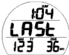
Fig. 4 - ÉCRAN SECONDAIRE ALT 1 DU MODE SURFACE NORM (données de la dernière plongée)
