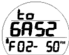
Fig. 79 - PRÉVISUALISATION DU PASSAGE AU MÉLANGE GAZEUX 2
