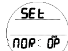
Fig. 41 - SÉLECTION DU MODE D'UTILISATION EN PLONGÉE
