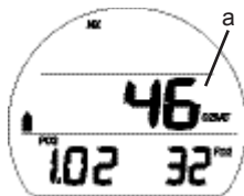
Fig. 51 - ÉCRAN COMPLÉMENTAIRE ALT 2 DE PLONGÉE SANS DÉCOMPRESSION
