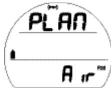
Fig. 8A - ÉCRAN D'ACCÈS AU MODE PLAN (mélange gazeux 1 réglé sur Air)
