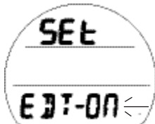
Fig. 98 - RÉGLAGE DE L'ALARME DE TEMPS DE PLONGÉE ÉCOULÉ
