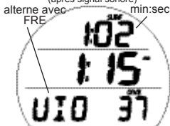
Fig. 110 - INFRACTION EN MODE FREE (après une minute en surface)
