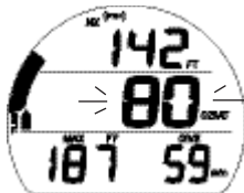
Fig. 75 - MISE EN GARDE O2 (pendant signal sonore)
