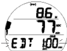
Fig. 106 - ALARME DE TEMPS DE PLONGÉE ÉCOULÉ
