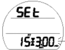
Fig. 30C - RÉGLAGE D'UN PALIER DE SÉCURITÉ TEMPS/PROFONDEUR
