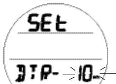
Fig. 24 - RÉGLAGE DE L'ALARME DE TEMPS DE PLONGÉE RESTANT
