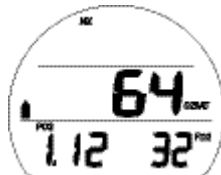
Fig. 65 - ÉCRAN COMPLÉMENTAIRE ALT 3 DE PALIER DE DÉCOMPRESSION
