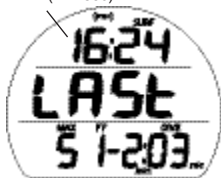
Fig. 91 - ÉCRAN SECONDAIRE ALT 1 DU MODE SURFACE FREE (données de la dernière plongée)
