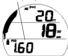
Fig. 74 - ALARME PO2 (pendant une phase de décompression)
