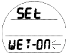
Fig. 27 - RÉGLAGE DE L'ACTIVATION PAR IMMERSION
