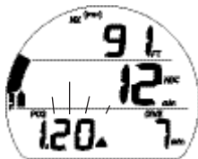
Fig. 72 - MISE EN GARDE PO2 (pendant signal sonore)
