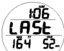
Fig. 82 - ÉCRAN SECONDAIRE ALT 1 DU MODE SURFACE GAUG (données de la dernière plongée)
