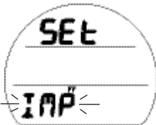
Fig. 28 - RÉGLAGE DES UNITÉS DE MESURES
