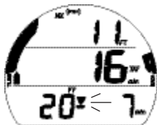
Fig. 66 - ÉCRAN PRINCIPAL D'INFRACTION PROVISOIRE (après signal sonore)
