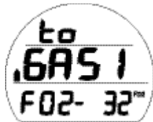
Fig. 78 - PRÉVISUALISATION DU PASSAGE AU MÉLANGE GAZEUX 1
