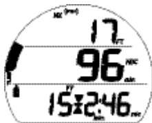
Fig. 59 - ÉCRAN PRINCIPAL DE PALIER DE SÉCURITÉ (réglé sur On. Profondeur/temps définis)
