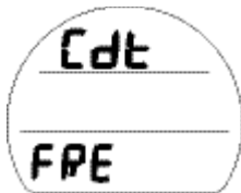
Fig. 93 - ÉCRAN D'ACCÈS AU MINUTEUR DE COMPTE A REBOURS
