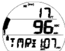
Fig. 60 - ÉCRAN PRINCIPAL DE PALIER DE SÉCURITÉ (défini avec minuteur)
