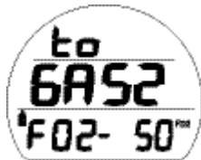
Fig. 79 - PRÉVISUALISATION DU PASSAGE AU MÉLANGE GAZEUX 2
