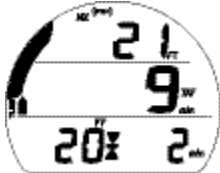
Fig. 62 - ÉCRAN PRINCIPAL DE PALIER DE DÉCOMPRESSION
