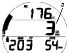
Fig. 52 - ÉCRAN PRINCIPAL DE PLONGÉE SANS DÉCOMPRESSION
