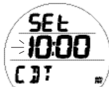
Fig. 96 - RÉGLAGE DU MINUTEUR DE COMPTE A REBOURS
