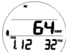
Fig. 65 - ÉCRAN COMPLÉMENTAIRE ALT 3 DE PALIER DE DÉCOMPRESSION
