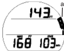
Fig. 48 - ÉCRAN PRINCIPAL DU MODE PLONGÉE (remontée normale)
