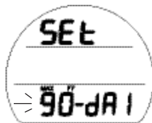
Fig. 99B - RÉGLAGE DE L'ALARME DE PROFONDEUR DA1
