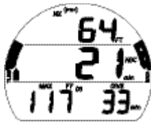
Fig. 53 - ÉCRAN PRINCIPAL DE PLONGÉE SANS DÉCOMPRESSION
