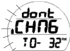
Fig. 80 - ALARME DE CHANGEMENT DE MÉLANGE GAZEUX (tout clignote)
