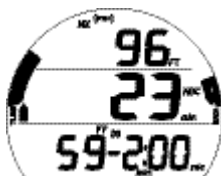
Fig. 57 - PRÉVISUALISATION D'UN PALIER PROFOND
