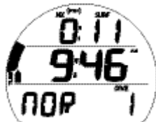
Fig. 3B - ÉCRAN PRINCIPAL DU MODE SURFACE NORM (>10 min après la plongée 1)
