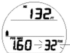
Fig. 16B - RÉGLAGE FO2 DU MÉLANGE GAZEUX 1
