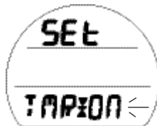
Fig. 30B - RÉGLAGE DU MINUTEUR DE PALIER DE SÉCURITÉ
