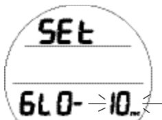
Fig. 33 - RÉGLAGE DU RÉTROÉCLAIRAGE
