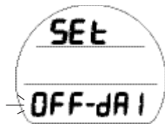
Fig. 99A - RÉGLAGE DE L'ALARME DE PROFONDEUR DA1
