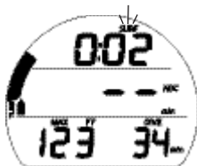
Fig. 54 - ÉCRAN PRINCIPAL DE PLONGÉE SANS DÉCOMPRESSION
