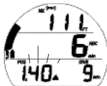
Fig. 73 - ÉCRAN PRINCIPAL D'ALARME PO2
