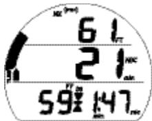
Fig. 58 - ÉCRAN PRINCIPAL DE PALIER PROFOND
