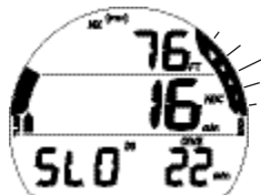
Fig. 49 - ÉCRAN PRINCIPAL DU MODE PLONGÉE (remontée trop rapide)
