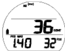
Fig. 6 - ÉCRAN COMPLÉMENTAIRE ALT 3 DU MODE SURFACE NORM (uniquement si Nitrox)
