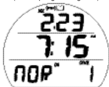
Fig. 11B - PRÉVISUALISATION DU MODE LOG (après la plongée 1 en mode NORM)
