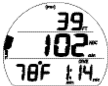
Fig. 101 - ÉCRAN PRINCIPAL DU MODE PLONGÉE FREE
