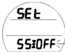
Fig. 30A - RÉGLAGE D'UN PALIER DE SÉCURITÉ SUR OFF
