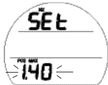
Fig. 25 - RÉGLAGE DE L'ALARME PO2
