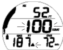
Fig. 77 - ALARME O 2 (pendant une phase de décompression)
