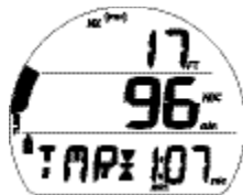
Fig. 60 - ÉCRAN PRINCIPAL DE PALIER DE SÉCURITÉ (défini avec minuteur)
