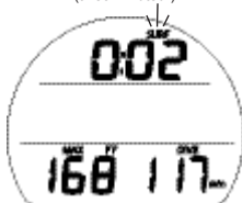
Fig. 86 - ÉCRAN PRINCIPAL DU MODE PLONGÉE GAUG (après moins de 10 min en surface)
