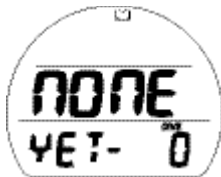
Fig. 11A - PRÉVISUALISATION DU MODE LOG (aucune plongée enregistrée)
