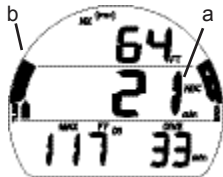
Fig. 50 - ÉCRAN PRINCIPAL DE PLONGÉE SANS DÉCOMPRESSION
