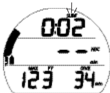
Fig. 54 - ÉCRAN PRINCIPAL DE PLONGÉE SANS DÉCOMPRESSION
