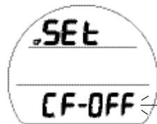
Fig. 32 - RÉGLAGE DU FACTEUR DE PRUDENCE
