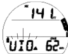
Fig. 70 - ÉCRAN PRINCIPAL D'INFRACTION AVEC LIMITATION AU MODE PROFONDIMÈTRE
