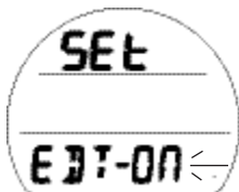
Fig. 98 - RÉGLAGE DE L'ALARME DE TEMPS DE PLONGÉE ÉCOULÉ
