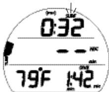
Fig. 102 - ÉCRAN PRINCIPAL DU MODE PLONGÉE FREE (après moins d'une minute en surface)
