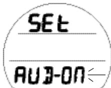
Fig. 20 - RÉGLAGE DU SI- GNAL SONORE D'ALARME
