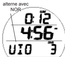
Fig. 71 - ÉCRAN PRINCIPAL SURFACE D'INFRACTION AVEC LIMITATION AU MODE PROFONDIMÈTRE
