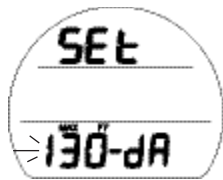
Fig. 21 - RÉGLAGE DE L'ALARME DE PROFONDEUR
