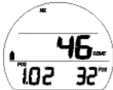
Fig. 56 - ÉCRAN COMPLÉMENTAIRE ALT 2 DE PLONGÉE SANS DÉCOMPRESSION
