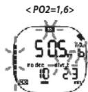
L'icône PO 2 , la valeur de PO 2 et la barre indicatrice de limite d'oxygène (OLI) clignotent et une alarme sonore retentit
