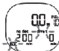
Toutes les icônes indiquées clignotent, et une alarme sonore retentit deux fois, trois secondes à chaque fois.
